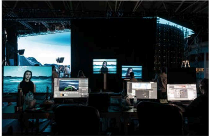
Die Regie des Hyperbowl ist klein gehalten. Zehn Unreal Server bespielen die LED-Wand direkt, für den Ton gibt es lediglich eine kleine Set-Beschallung.
